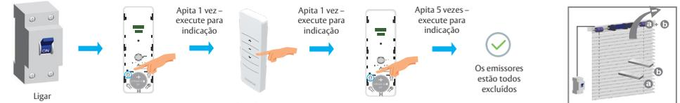
**NOTA:** Limpar o emissor significa apagar toda a memória do emissor e do interruptor de limite nos receptores do motor.
