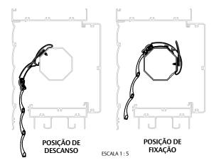
**IMPORTANTE:** TOME CUIDADO AO FAZER A FIXAÇÃO. EVITE UTILIZAR PARAFUSOS MUITO COMPRIDOS PARA QUE NÃO TOQUEM OU PERFUREM O CORPO DO MOTOR.
