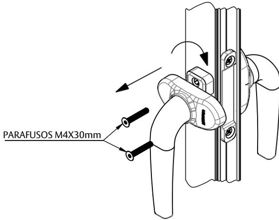
**PASSO 8:** GIRAR DE VOLTA A CAPA DA MAÇANETA PARA A POSIÇÃO ORIGINAL.
