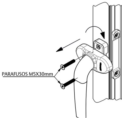
**PASSO 6:** GIRAR DE VOLTA A CAPA DA MAÇANETA PARA A POSIÇÃO ORIGINAL.
