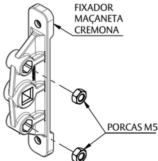
**PASSO 2:** MONTAR O FIXADOR MAÇANETA CREMONA NO PERFIL UTILIZANDO OS PARAFUSOS 4,2X13mm PRESENTES NO KIT. DEIXAR A PORCA POSICIONADA DO LADO OPOSTO A USINAGEM DOS PARAFUSOS.
