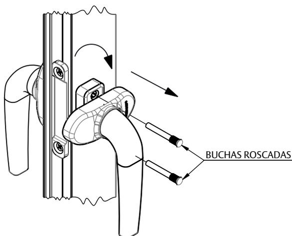
**PASSO 6:** GIRAR DE VOLTA A CAPA DA MAÇANETA PARA A POSIÇÃO ORIGINAL.
