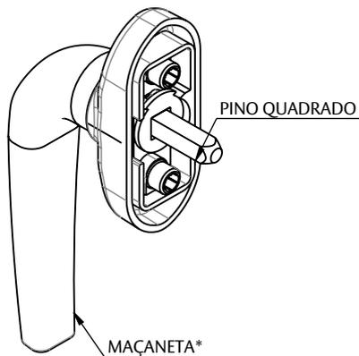
**PASSO 4:** MANTENDO A MAÇANETA PARA BAIXO, ENCAIXAR O PINO QUADRADO NO FIXADOR.
