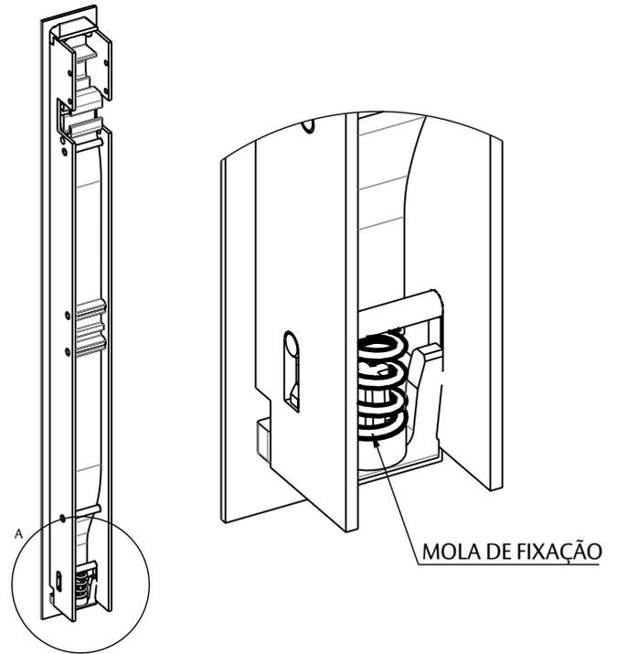
2. Pressionar a extremidade da Concha que não possui a mola contra a parede da usinagem do perfil (F1). Em seguida, pressionar a outra extremidade contra o perfil da esquadrinha (F2) até que seja feito o encaixe como mostra a figura ao lado.
