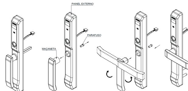
Caso necessário, a programação eletrônica do lado de abertura pode ser alterada na fechadura, fazendo o reset de fábrica (vide página 4).
