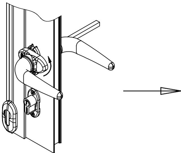
3º PASSO: Encaixar a haste pelo outro lado do perfil até encostar no fundo da maçaneta instalada no lado oposto
