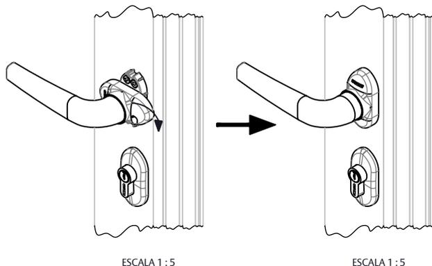
**PASSO 3:** ENCAIXAR A HASTE PELO OUTRO LADO DO PERFIL ATÉ ENCOSTAR NO FUNDO DA MAÇANETA INSTALADA.
