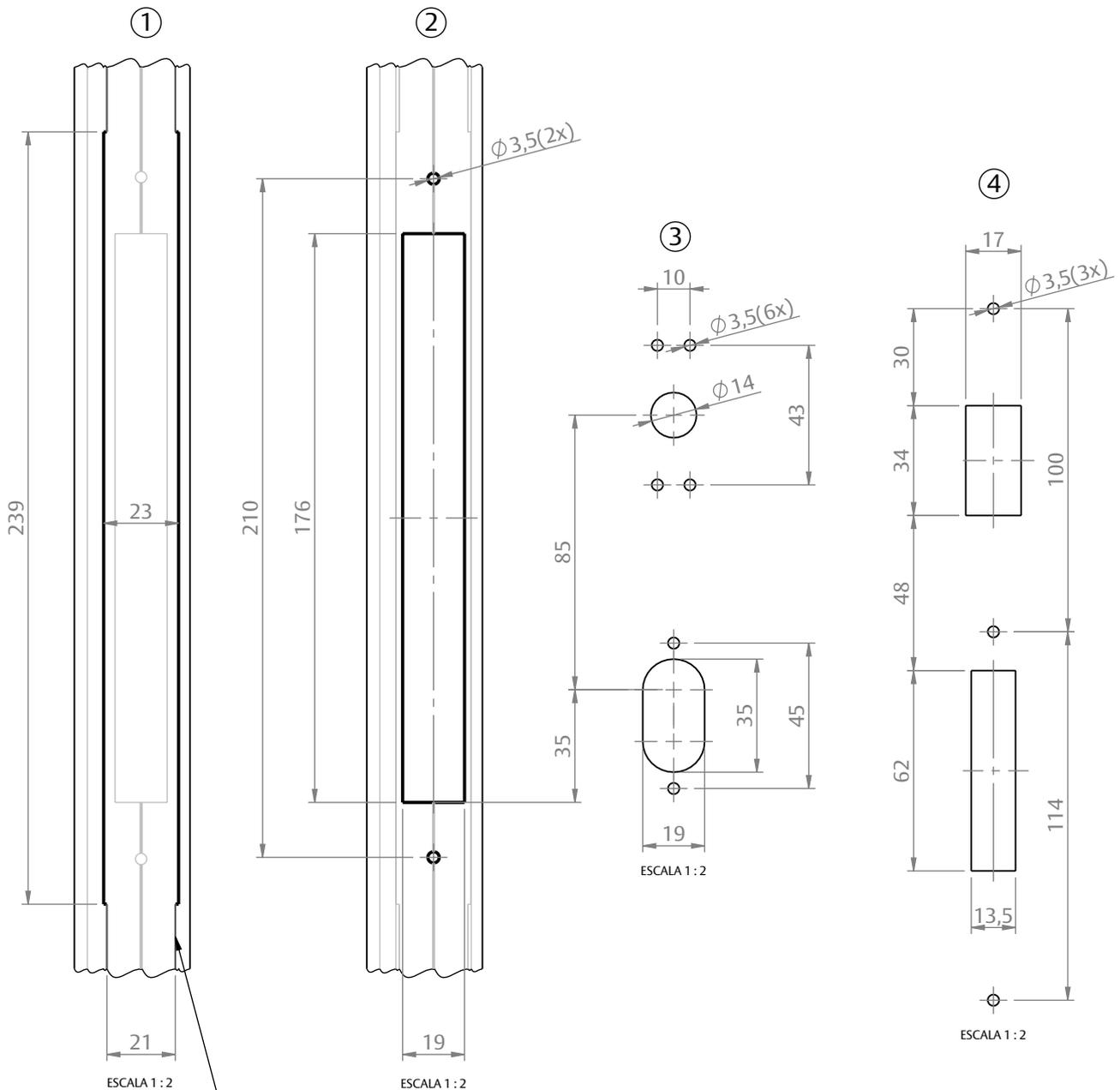
**USINAGEM DA TESTA DA FECHADURA:**
