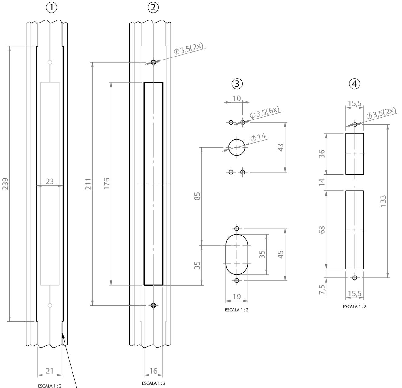
**USINAGEM DA TESTA DA FECHADURA:**
