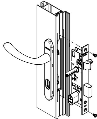
3. POSICIONAR BASES DO ESPELHO NO PERFIL E FIXAR COM PARAFUSOS AUTO ATARRAXANTES E CLICAR ESPELHOS NA BASE.
