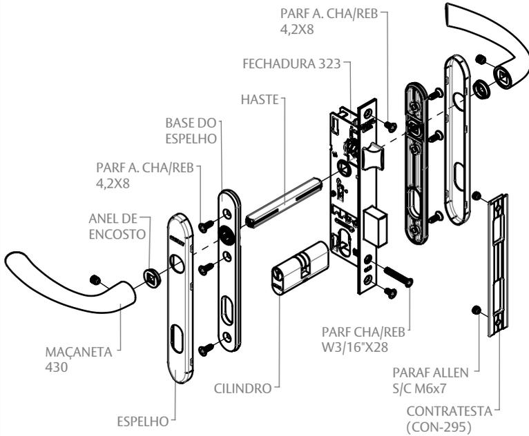
2. APÓS FIXAR FECHADURA 323, POSICIONAR CILINDRO E FIXAR COM PARAFUSO.
