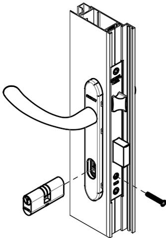
4. ENCAIXAR A HASTE NA MAÇANETA ATÉ APOIAR NO FUNDO DO CUBO, FIXAR A MAÇANETA COM PARAFUSO ALLEN SEM CABEÇA, POSICIONAR O ANEL DE ENCOSTO NO ESPELHO, ATRAVESSAR A HASTE JÁ MONTADA NA MAÇANETA PELA FECHADURA E POSICIONAR O OUTRO ANEL DE ENCOSTO E A OUTRA MAÇANETA NO LADO OPOSTO.
