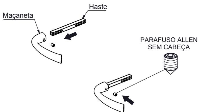
**5º PASSO:** Atravessar a Maçaneta montada na Haste (conforme 4º passo) pela fechadura e posicionar o outro Anel de Encosto e a outra Maçaneta no outro lado.
