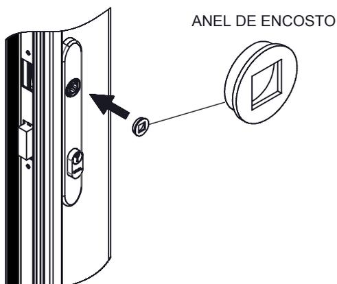
**4º PASSO:** Fixar a Haste na Maçaneta com o Parafuso Allen Sem Cabeça, conforme ilustração abaixo.
