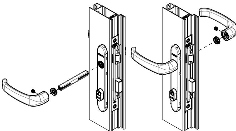
1. APÓS A USINAGEM DO PERFIL POSICIONAR A FECHADURA 323 NO CANAL E FIXAR COM OS PARAFUSOS AUTO ATARRAXANTES, CONFORME ILUSTRAÇÃO ABAIXO.
