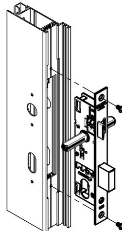
3. POSICIONAR BASES DO ESPELHO NO PERFIL E FIXAR COM PARAFUSOS AUTO ATARRAXANTES E CLICAR ESPELHOS NA BASE.
