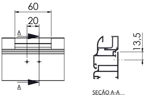
2º PASSO: Encaixar as tampas na contrabase e em seguida clicar a contrabase na travessa e parafusar conforme figura abaixo:
